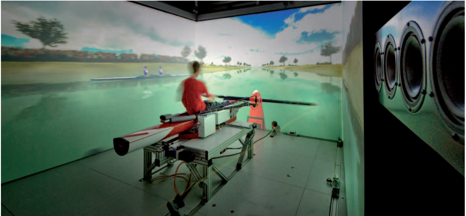
Der Rudersimulator des SMS Lab der ETH Zürich und der Universität Zürich testet die Bewegungsabläufe von Ruderern in einer halb realen, halb virtuellen Umgebung. Um alle Risiken für die beteiligten Personen auszuschliessen, prüft das Lab jedes Detail der Versuchsanordnung. (SMS Lab/ETH Zürich)
